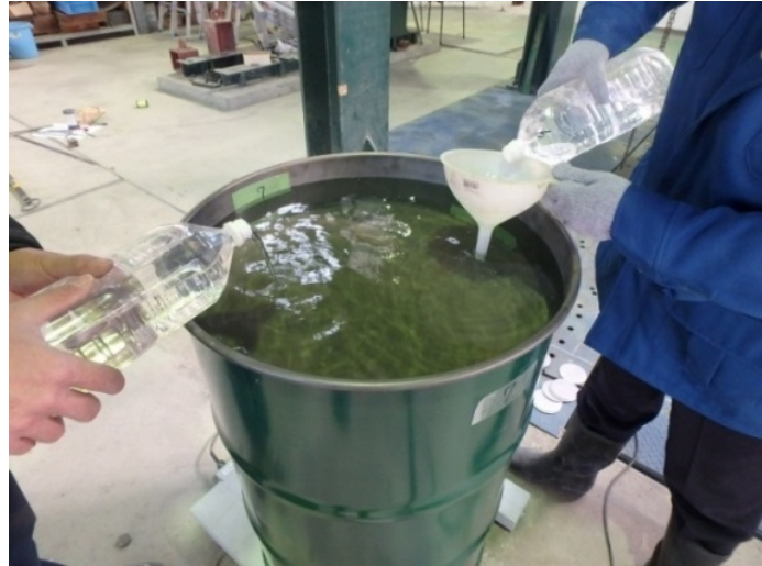
写真 34 硬化後の試験体への水の注入
