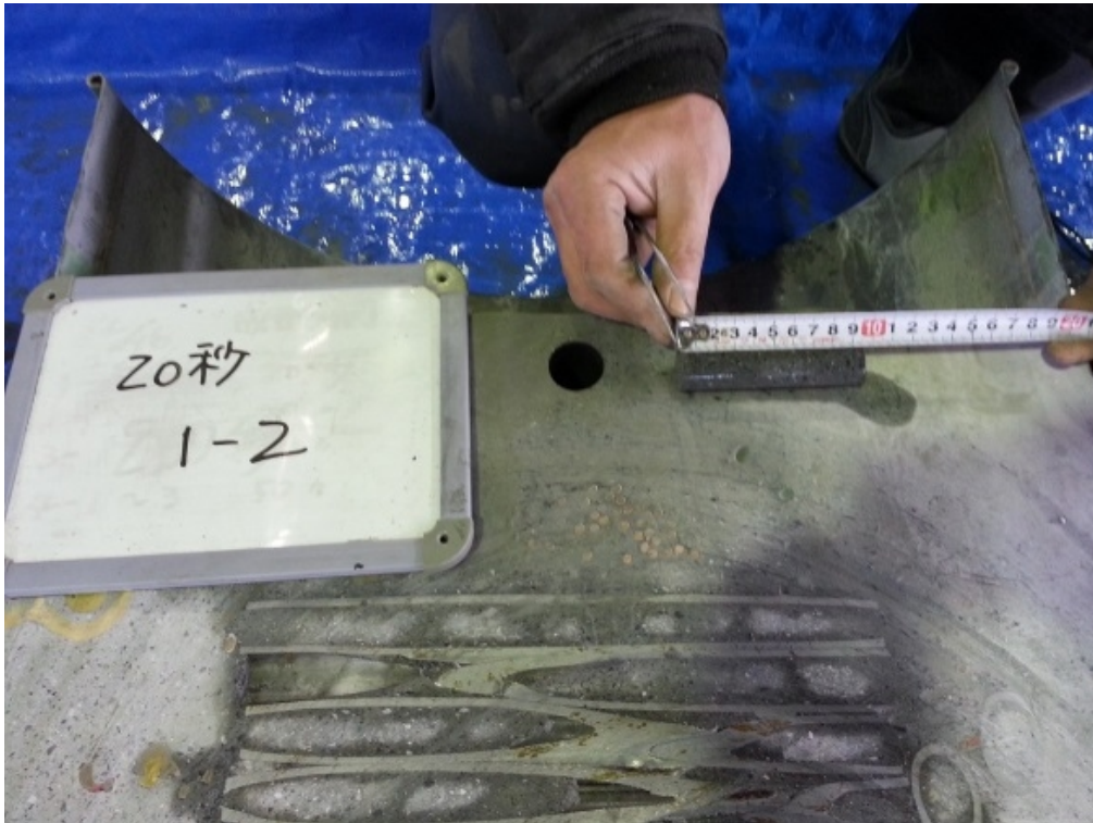
図 3-2 切断した試験体からの小口径コアの抜き取り後の状況
