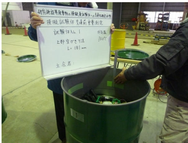
写真 15 上部空げき 20%に相当するドラム缶天端からの深さの測定状況
