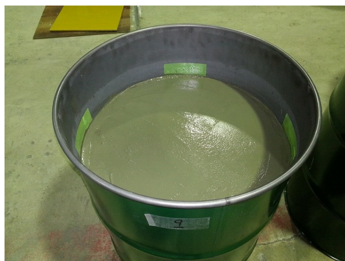
写真 24 P ロート流下時間 40 秒のモルタルを充填した試験体の充填後の状況
