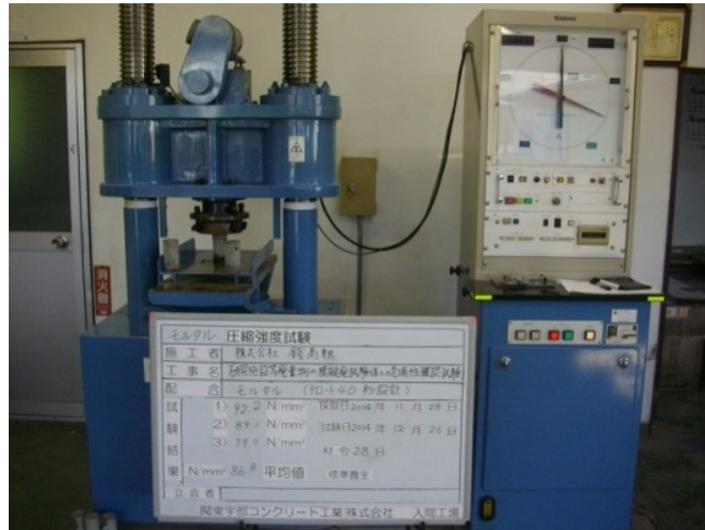
写真 10 一軸圧縮強度試験の実施状況
