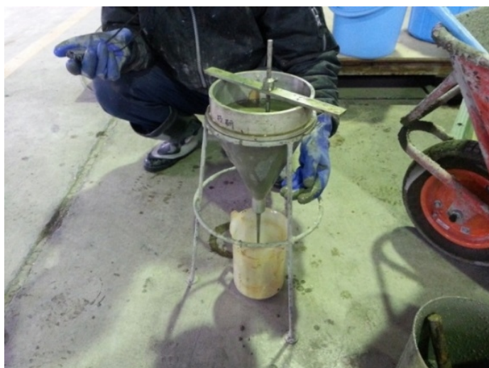
写真9 Pロート試験の実施状況
