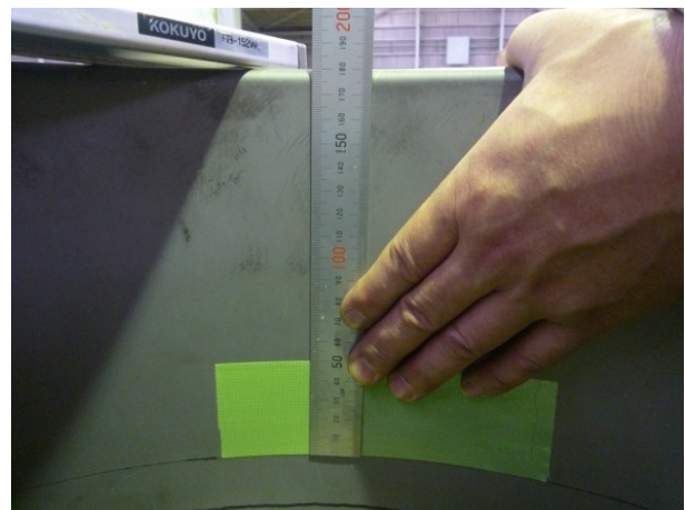
写真 15 上部空げき 20%に相当するドラム缶天端からの深さの測定状況
