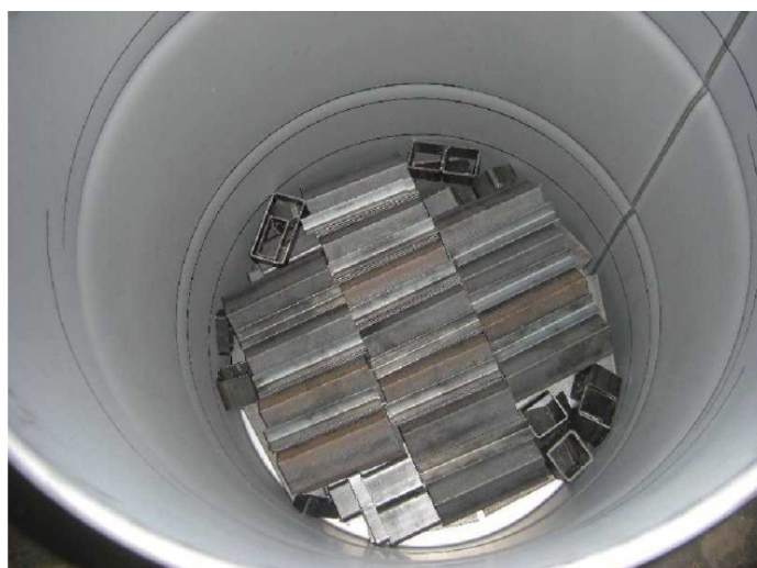
写真2 金属板の上にアングル材を収納した状況
