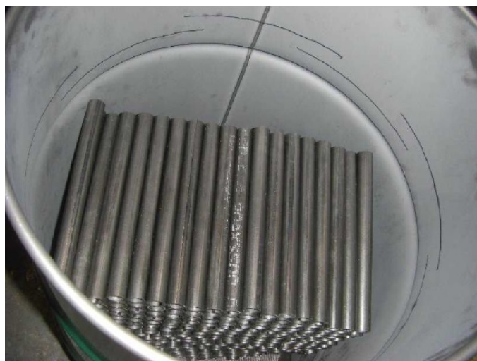
写真4 ボルト・ナットの上に口径 20A、長さ 30cm の配管 270 本を水平収納した状況
