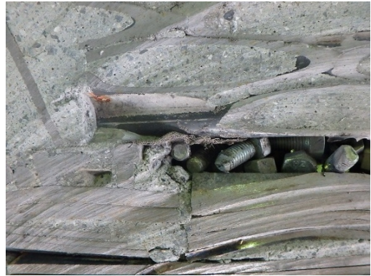
図 5-12 試験体 No.10 充填状況 (P ロート流下時間 50 秒)
