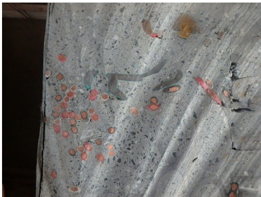
図 5-7 試験体 No.7 充填状況 (P ロート流下時間 40 秒)
