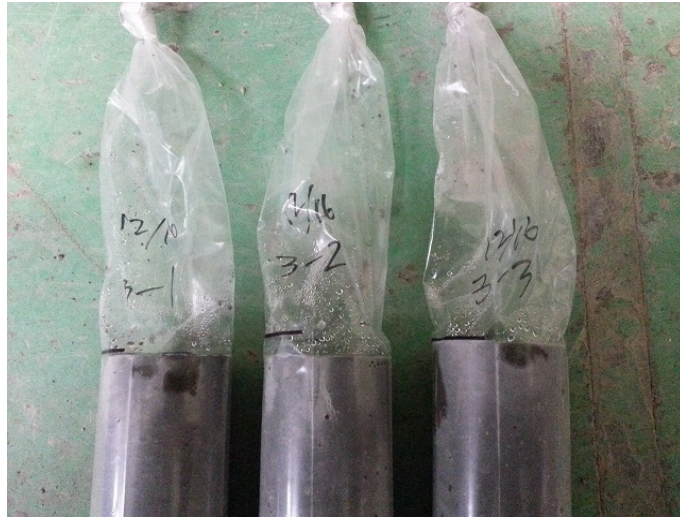
写真 31 ブリーディング水の有無(P ロート流下時間 40 秒の試料)
