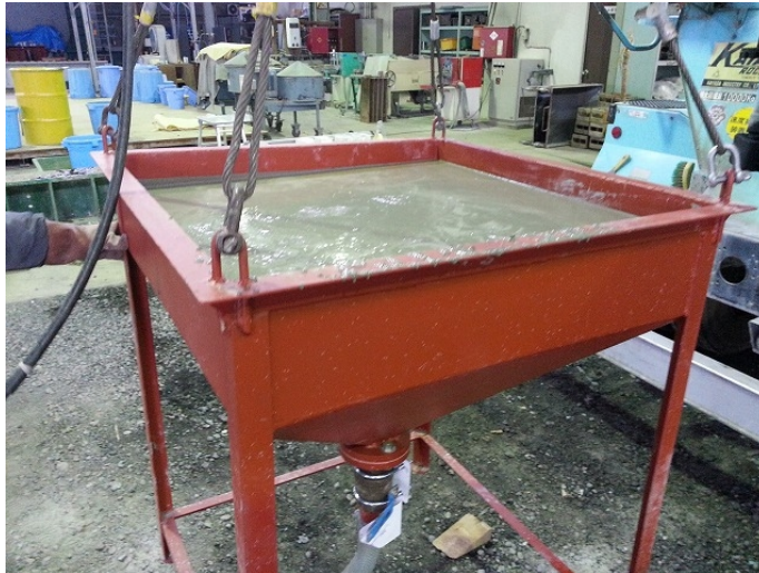
写真 13 ホッパへの投入完了時
