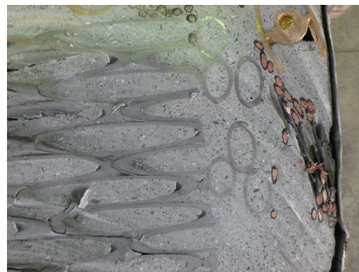
図 5-4 試験体 No.10 充填状況 (P ロート流下時間 50 秒)
