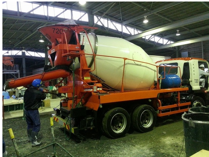
写真 11 アジテータ車による運搬
