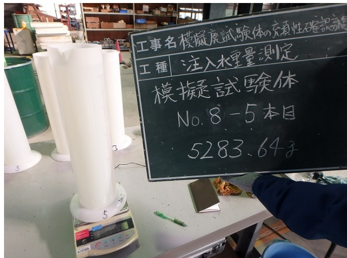
写真 33 硬化後の試験体への水の注入重量の測定
