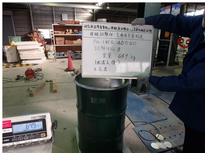
写真 36 硬化後の試験体及び注入水の重量測定
