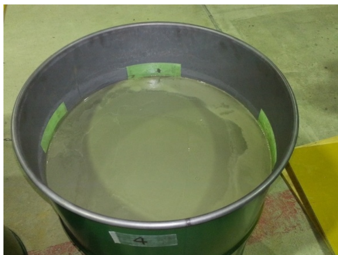
写真 23 P ロート流下時間 30 秒のモルタルを充填した試験体の充填後の状況
