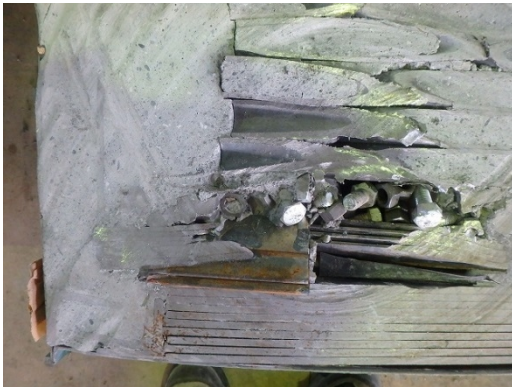
図 5-11 試験体 No.7 充填状況 (P ロート流下時間 40 秒)
