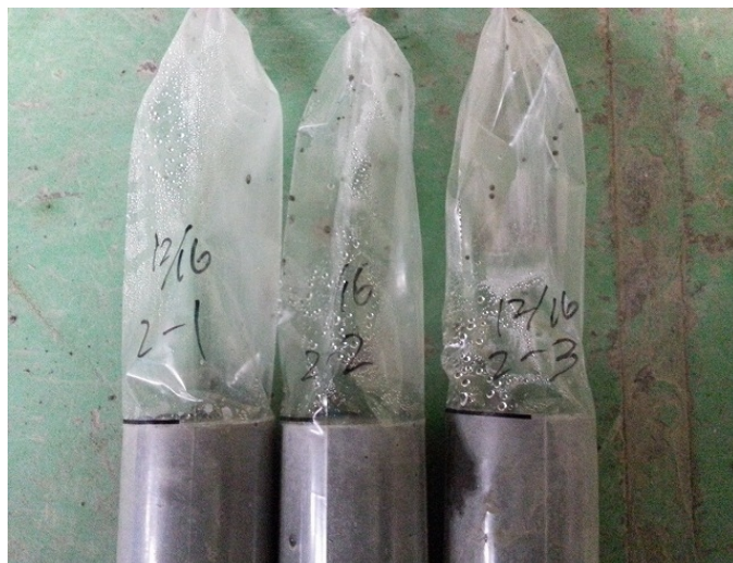
写真 30 ブリーディング水の有無(P ロート流下時間 30 秒の試料)
