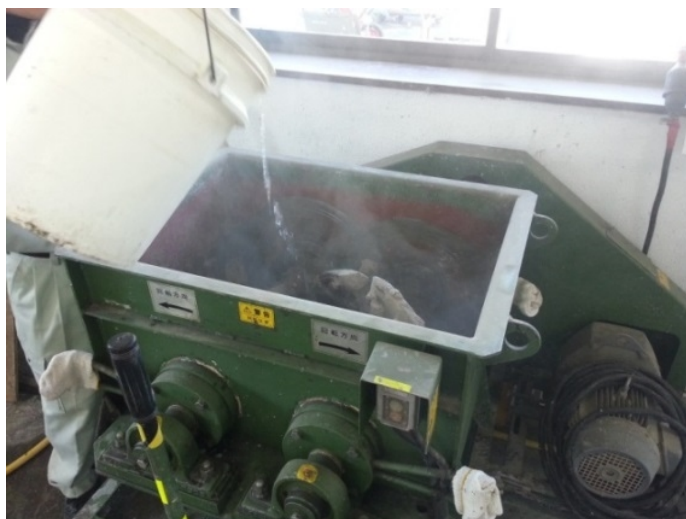
写真8 50リットル強制二軸ミキサでの練り混ぜの状況
