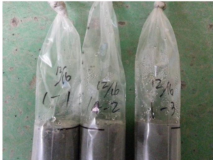
写真 29 ブリーディング水の有無(P ロート流下時間 20 秒の試料)
