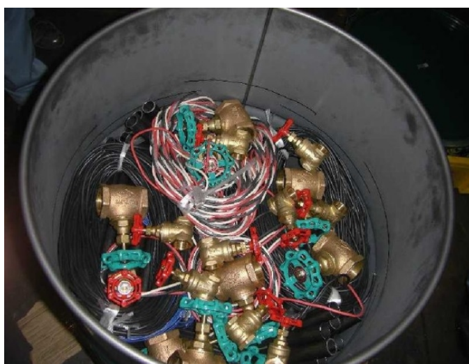
写真6 水平収納した配管の上にケーブル、弁類を収納した状況
