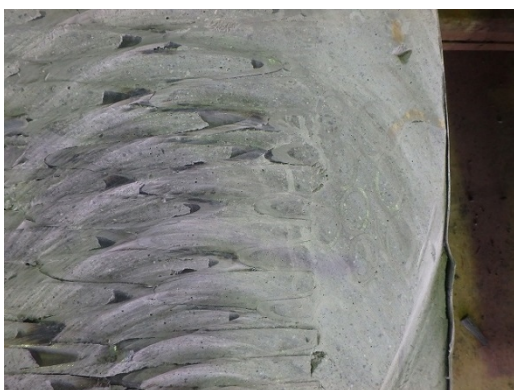
図 5-3 試験体 No.7 充填状況 (P ロート流下時間 40 秒)
