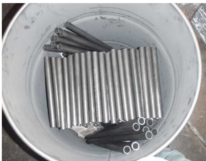
写真5 水平収納した配管の側部に口径 20A、長さ 60 cm の配管を収納した状況
