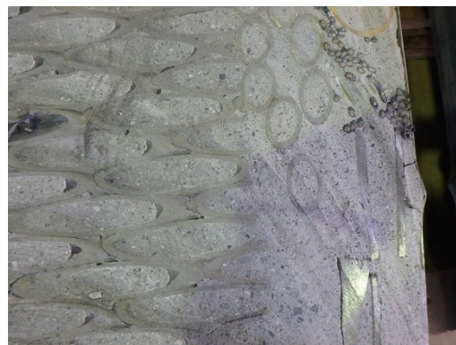
図 5-2 試験体 No.4 充填状況 (P ロート流下時間 30 秒)
