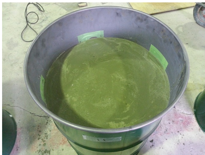
写真 25 P ロート流下時間 50 秒のモルタルを充填した試験体の充填後の状況
