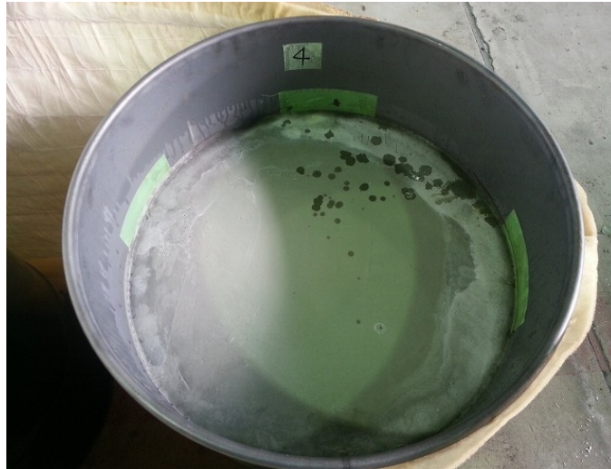
写真 28 P ロート流下時間 30 秒のモルタルを充填した試験体の硬化後の状況
