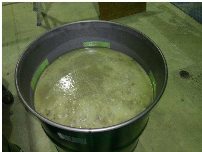
写真 22 P ロート流下時間 20 秒のモルタルを充填した試験体の充填後の状況
