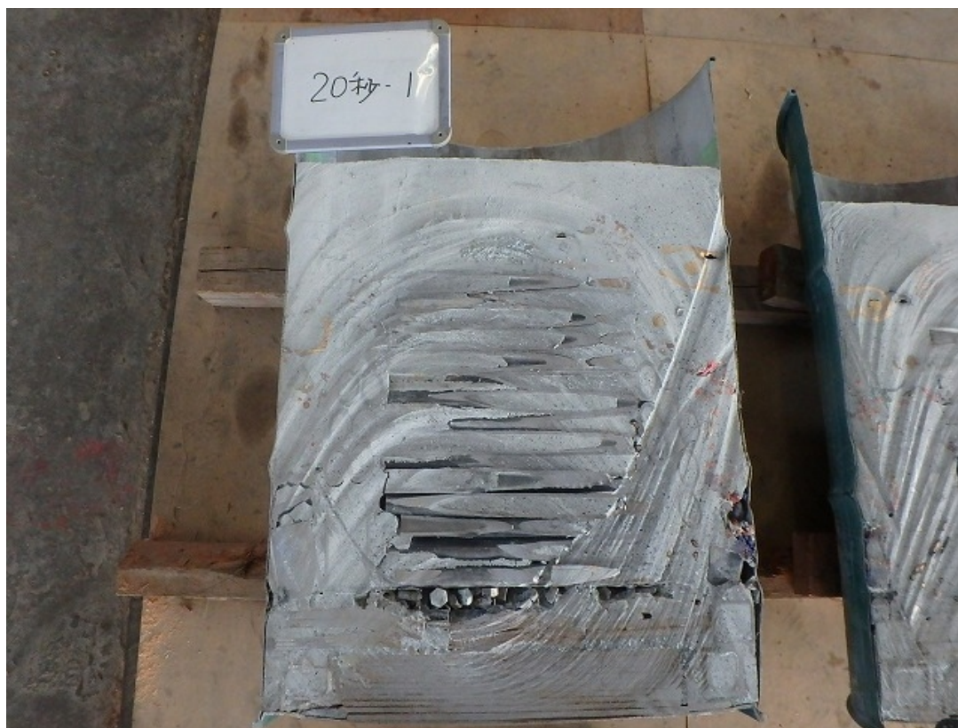
写真 37 試験体の断面(充填材の P ロート流下時間 17 秒)
