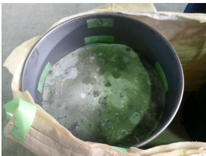
写真 26 P ロート流下時間 20 秒のモルタルを充填した試験体の硬化後の状況
