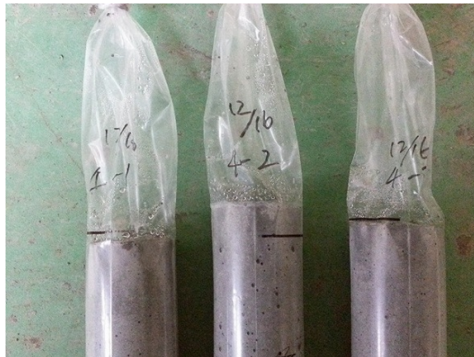
写真 32 ブリーディング水の有無(P ロート流下時間 50 秒の試料)
