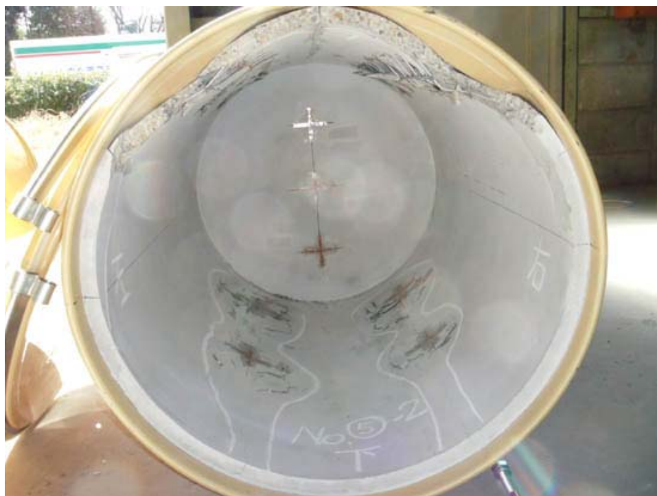
図 68 D-20(試験体No.1)の裁荷後の変形の状況(1/2)
