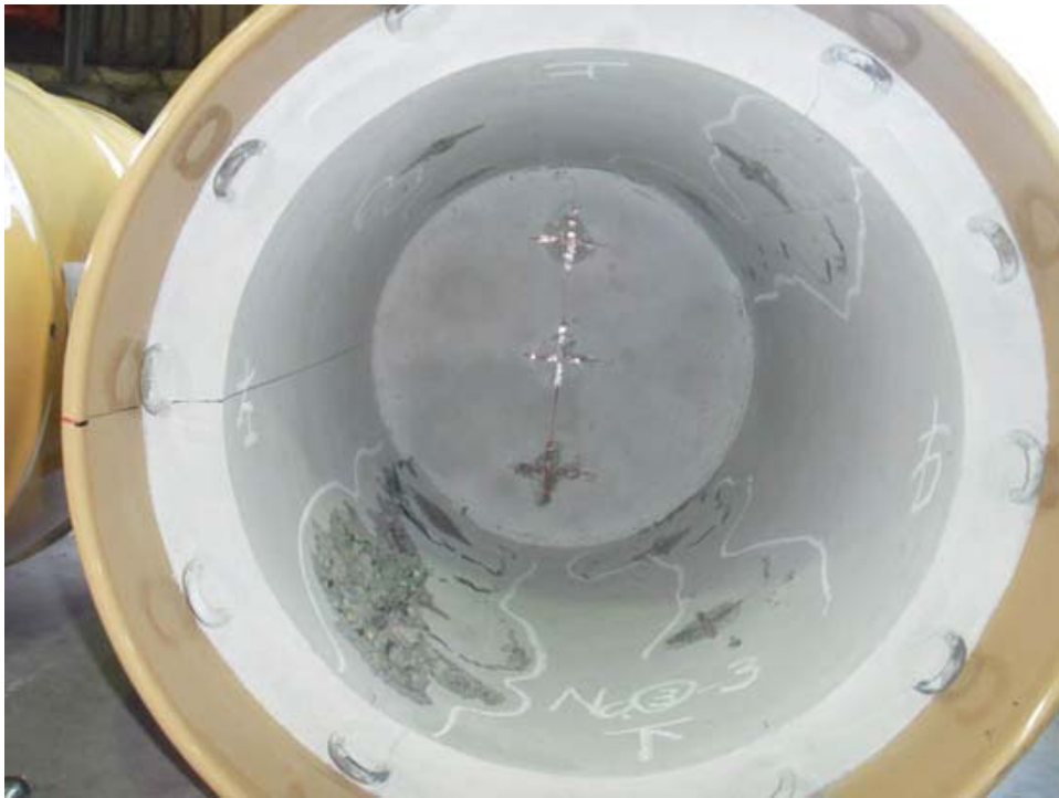
図 106 D-50-75(試験体No.2)の裁荷後の変形の状況(2/2)
