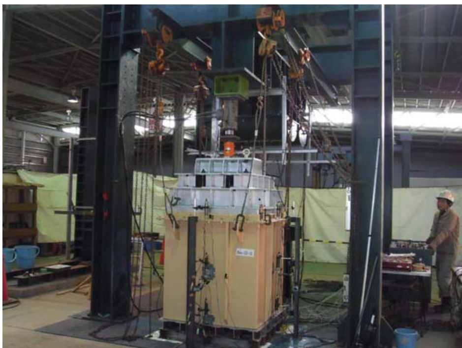
図6 角形容器の設置状況
