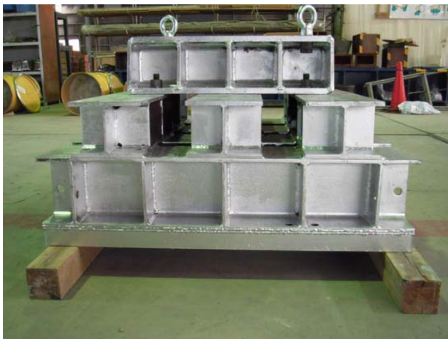
図5 角形容器の上部の载荷梁と特殊治具
