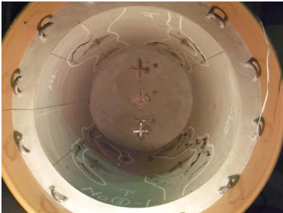
図 106 D-50-75(試験体No.1)の裁荷後の変形の状況(1/2)
