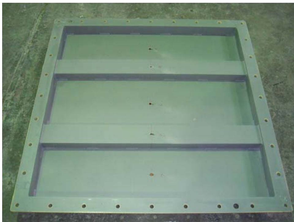
図 144 角型容器(試験体No.1、上:容器外観、下:蓋裏面)の裁荷後の状況(1/2)
