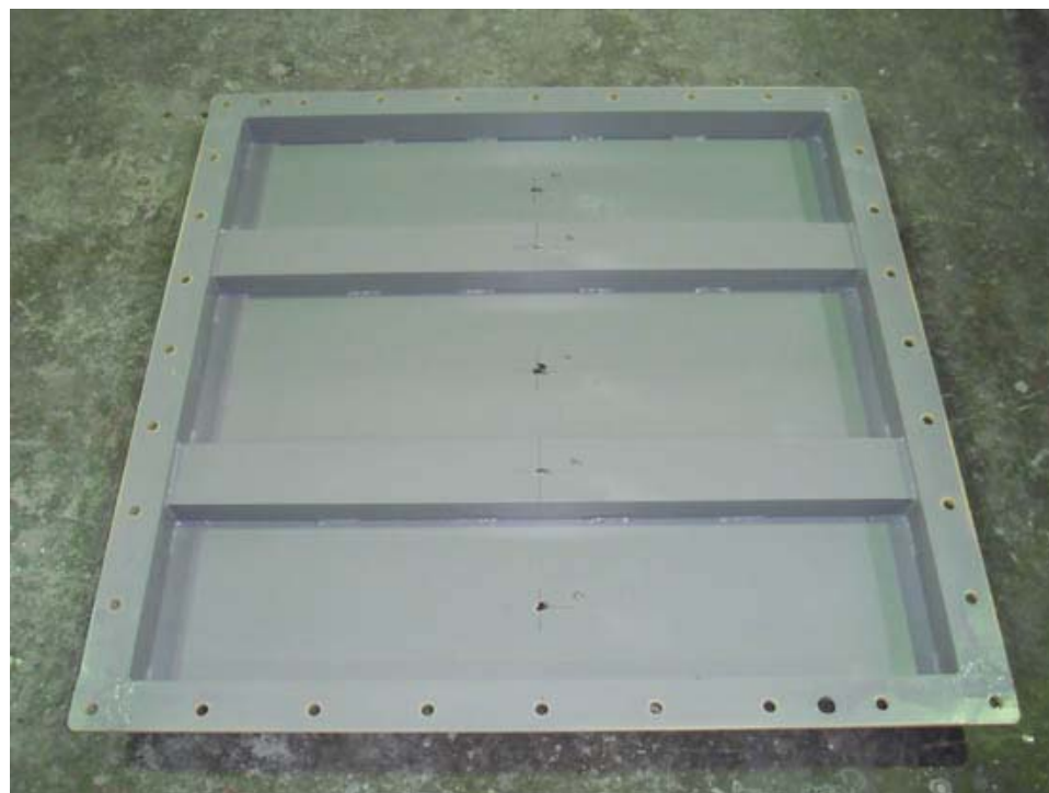
図 144 角型容器(試験体No.2、上:容器外観、下:蓋裏面)の裁荷後の状況(2/2)
