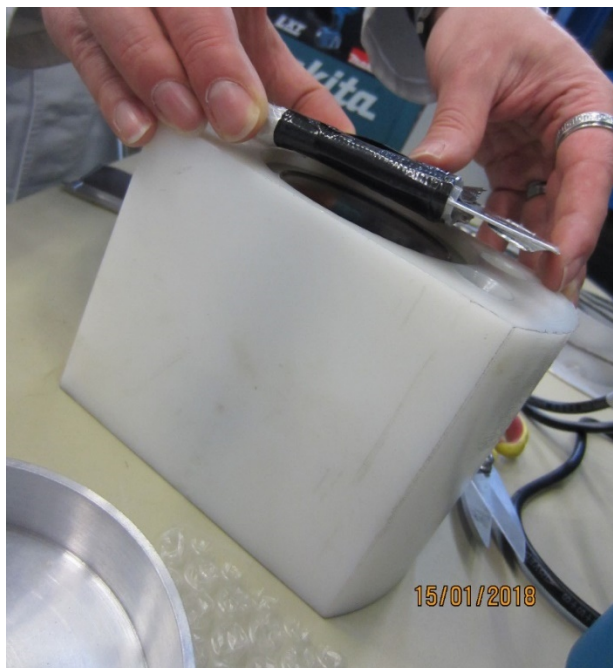
図2 円筒形のウラン標準試料（サンプルホルダー内部）とコイン形状の PuGa 試料（蓋）を設置する様子
