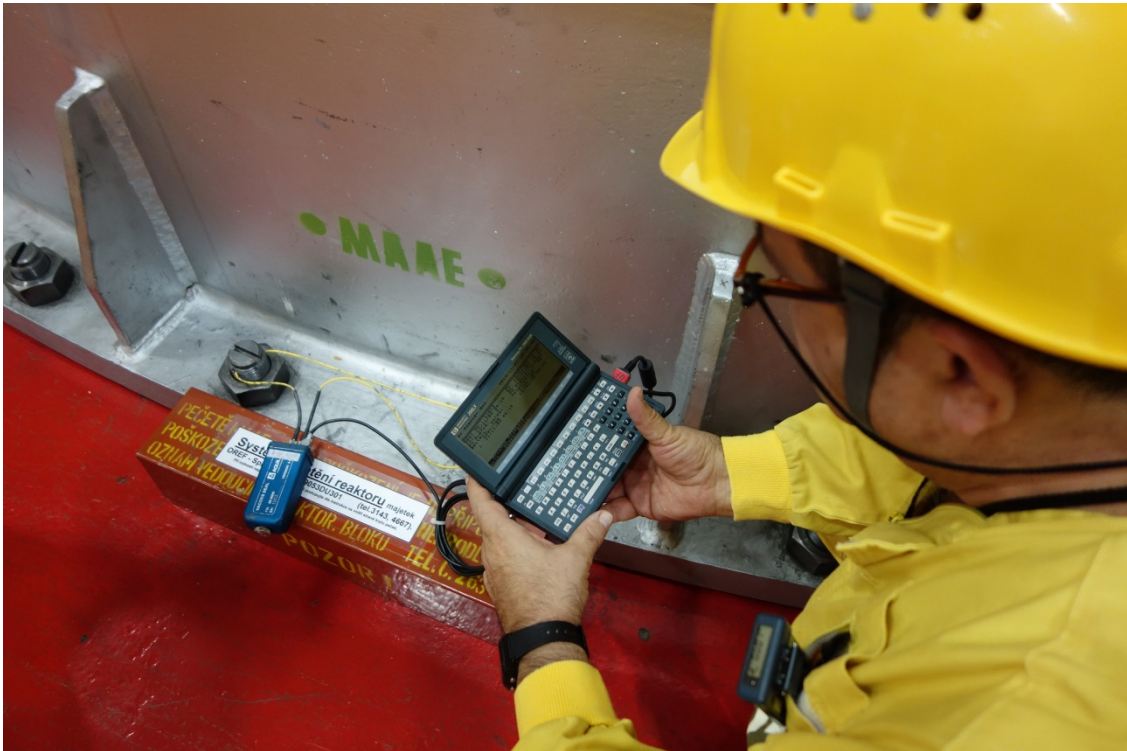
炉心容器の上蓋に VACOSS シールを貼付する IAEA 査察官 写真提供 : IAEA Imagebank
