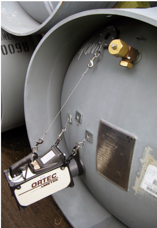
UF6 濃度の検証に使用する電気制御型ゲルマニウム冷却システム
