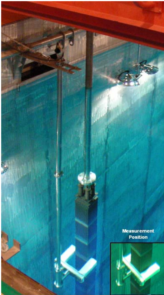
プール型原子炉の使用済み燃料集合を測定する
