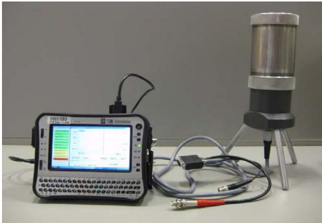
NaI 検出器を含む小型マルチチャンネル分析器 写真提供：IAEA
