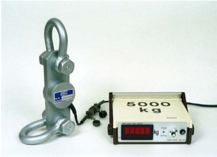
5,000 kg まで計測可能なロードセル
