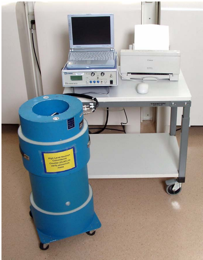
プルトニウム質量の測定に使用する高水準中性子同時計数装置
