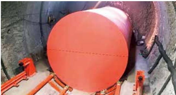
写真2 PEMの周りの隙間を埋める試験の様子（左：下部の隙間に粘土を充填している様子、右：上部の隙間に粘土と砂を1：1の割合で混ぜた材料を吹付けている様子）
