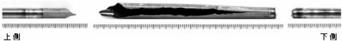
図 2 NSRR 実験で破損した燃料棒 (ZIRLO 被覆 PWR-UO 2 燃料, 燃焼度 : 79 GWd/t)
