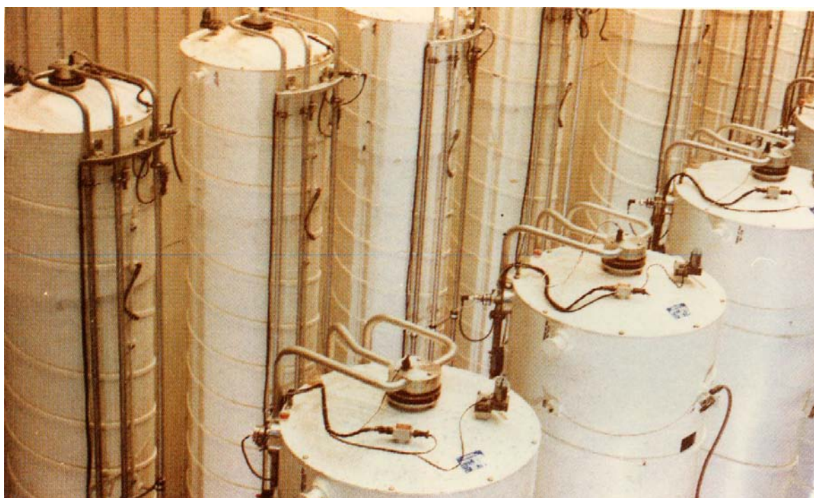
写真4 DOE の GCEP 計画の大型遠心機
