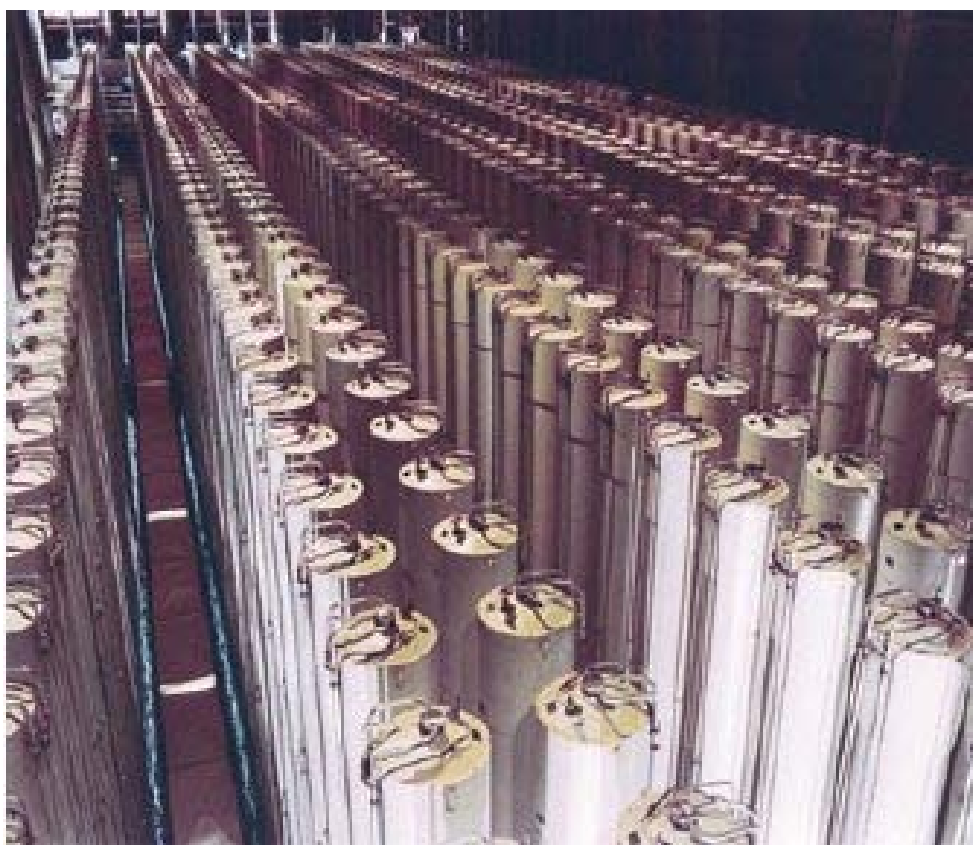
写真5 DOEのポーツマス施設内のGCEP計画商業実証設備
