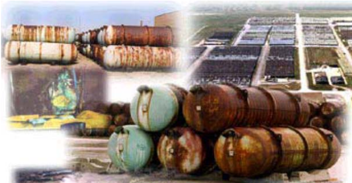
写真 8 DOE 所有劣化 UF 6 シリンダーの保管状況 41)
