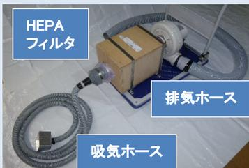
①局所排気装置の一例(試作品)
