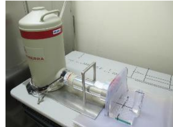
高純度ゲルマニウム検出器 (プルトニウム同位体組成比を測定)
