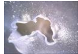
試験による穴 (約6.65mm)
