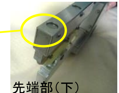
試験に使用した熱溶着装置ヘッド部 (当時使用していたものと同じタイプ)
