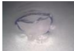
試験による穴 (約4.90mm)
