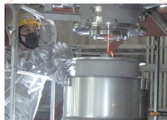
新型溶融炉の鳥瞰図(上) / 新型溶融炉での模擬廃液を用いた試験の様子(下)
