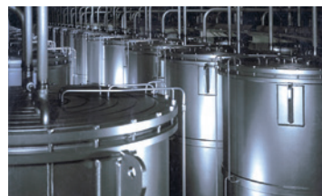
ウラン濃縮原型プラント DOP-2遠心分離機 (1989年運転開始)
