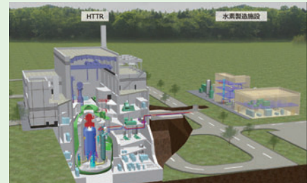
HTTRを用いた原子炉水素製造システム概念例
