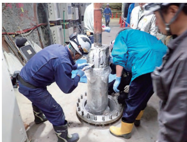
オーバーパック腐食試験の試験体の 取り出し・試料採取の様子
