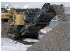
① 破碎による資源化加工 (自走式破碎機による破碎)
