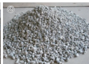
② 資源化加工後のコンクリート (RC40材)
