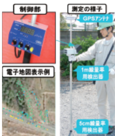
製品化された「ガンマプロッターH」 (軽量で、持ち運び・操作が容易)
