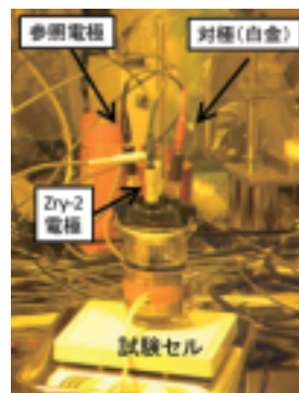
ジルカロイ製被覆管の腐食試験
