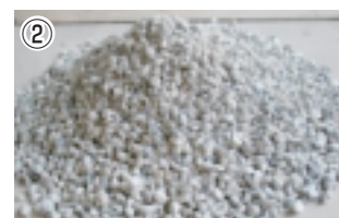
② 資源化加工後のコンクリート (RC40材)
