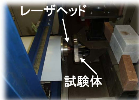
気中切断試験装置
