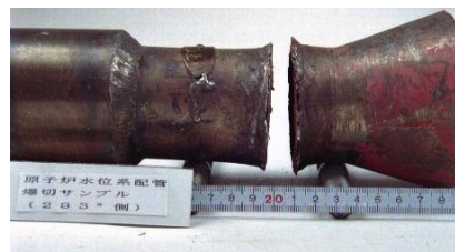
成型爆薬により切断した配管
