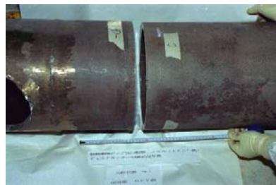
ディスクカッターにより切断した配管
