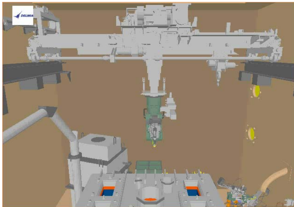
3Dシミュレーションを用いたケーシングの切断手順
